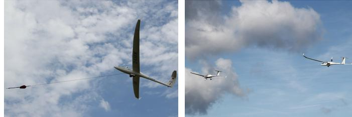
Windenstart und Flugzeugschlepp
